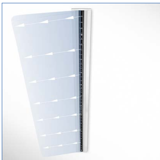
Poziomy, jednostronny wypływ powietrza w lewo
